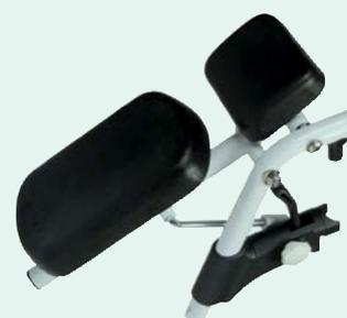
**Les coussinets de soutien latéraux** sont en polyuréthane moulé et sont montés sur le tube arrière du siège, elles sont réglables selon les besoins de l'utilisateur. Les coussinets sont disponibles en 2 tailles 10 x 14 cm ou 14 x 20 cm
